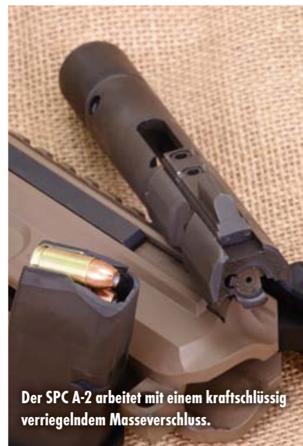
Griffstück und Systemkasten sind mit Minimaltoleranzen aufeinander abgestimmt.
