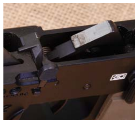
Der Ausstoßer ist äußerst robust gebaut.
