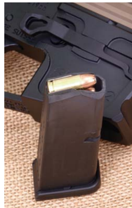
Gefüttert wird der SPC A-2-Pistolenkarabiner praktischerweise mit Glock-Magazinen, die von vielen Herstellern mit unterschiedlichsten Fassungsvermögen angeboten werden.
