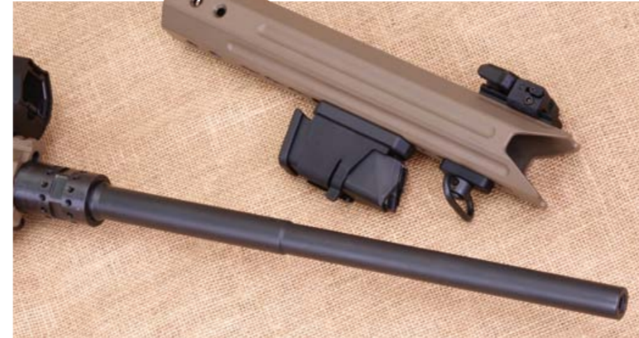
Enge Toleranzen erreicht man auch hier, weil der einteilige Leichtmetall-Handschutz mit einer eingepressten Hülse auf der Laufbefestigungsmutter am Systemkasten sitzt.
